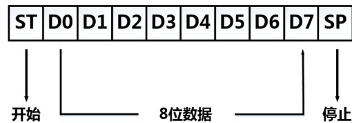
图 7. Modbus 通信格式
