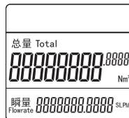
(图6-2) 流量计正常工作显示
