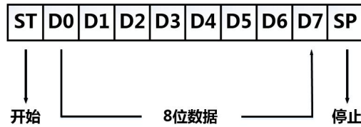
图 7. Modbus 通信格式
